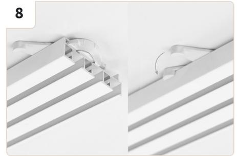
Beginnen Sie mit der Montage der linken Laufschiene. Die Bügel der Halterungen sind zur Fensterwand ausgerichtet. Heben Sie die Laufschiene zur Decke, so dass die Halterungen in der Nut sitzen. Drehen Sie die Halterung am Bügel bis dieser in der Schiene einrastet.
