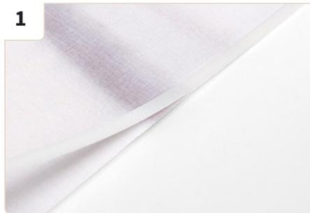
Kleben Sie jeweils einen Klebekeder auf die Rückseite bündig zur oberen und unteren Stoffkante an.
