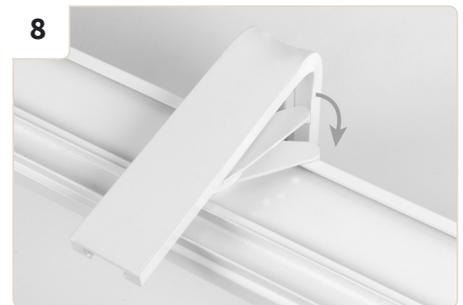
Beginnen Sie mit der Montage der linken Schiene. Die Bügel der Halterungen sind zur Fensterwand ausgerichtet. Heben Sie die Laufschiene zum Winkel, so dass die Halterungen in der Nut sitzen. Drehen Sie die Halterung am Bügel bis dieser in der Schiene einrastet.
