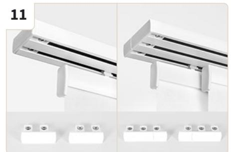
Führen Sie die Textilpaneele in der gewünschten Reihenfolge in die Schienen ein. Trennen Sie die benötigten Schienenabdeckungen ab und schrauben Sie diese an den beiden Schienenenden fest.
