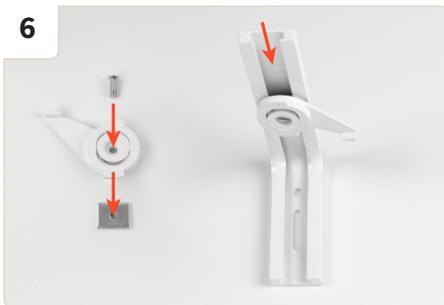
Bereiten Sie die Wandhalterung wie in Bild 6 gezeigt vor, indem Sie die einzelnen Komponenten zusammenschrauben (links). Führen Sie dann die Halterung in die Winkel (rechts). Achtung: Halterung nur so fest schrauben, dass sie sich weiterhin drehen lässt.
