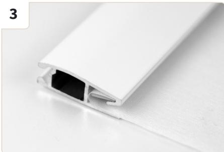
Schlagen Sie den Stoff an der Unterkante einmal um den Klebekeder. Schieben Sie diesen von der Seite in das Beschwerungsprofil, so dass der umgeschlagene Stoff hinter der Metallkante einhakt.
